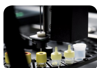
ДОЗИРОВАНИЕ ПРОБ В АНАЛИЗАТОРЕ ALFRED 60
